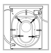
3. Csavarozza ki a gép hátsó részén található, a szállításhoz szükséges 4 védőcsavart, és távolítsa el a gumibakot (lásd ábra).
